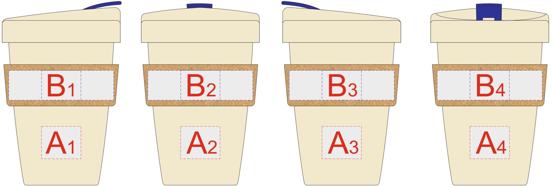
Внимание! В связи с особенностью структуры пробковой поверхности гравировка в зоне В будет неоднородна. Нанесение может гулять по высоте на 2-3 мм.
